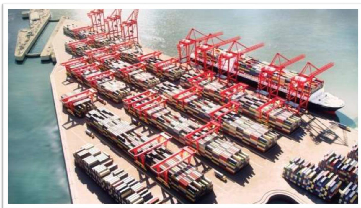
รูปที่ 3-7: การใช้งานระบบอัตโนมัติในรูปแบบ Cantilever ASC with terminal tractors ที่ Peel Port
