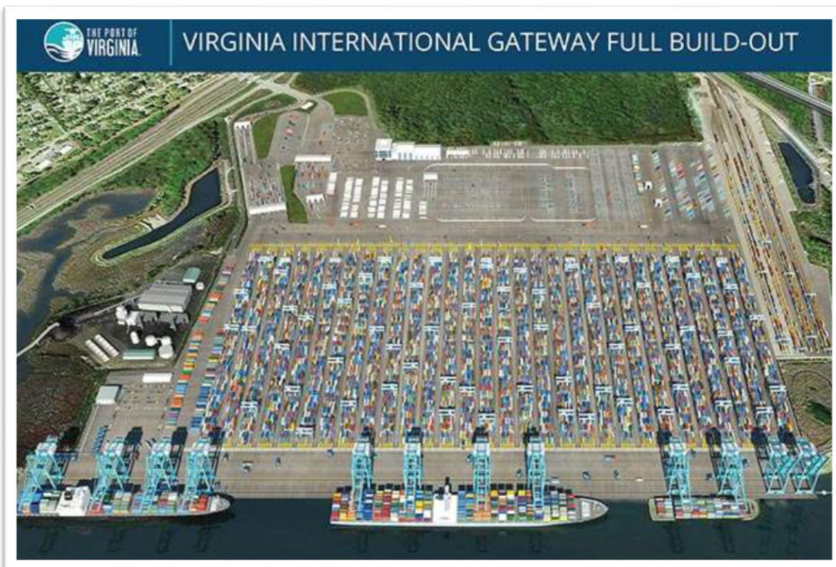
รูปที่ 3-6: การใช้งานระบบอัตโนมัติในรูปแบบ Twin ASC with Auto Straddle carrier model ที่ท่าเรือ Port of Virginia
